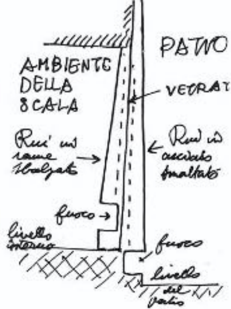
il ramino a due bocche, fra la scala e il patio
